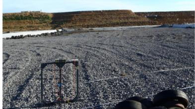
Dans le cadre de l'édification de casiers dans les centres d'enfouissement technique (CET), lors d'aménagement de bassins d'altitude, les dommages des géomembranes surviennent principalement pendant la pose du confinement. GeoTT® est un nouvel outil électrique émetteur/récepteur mis au point par ArkoGéos qui permet de détecter ces perforations.
