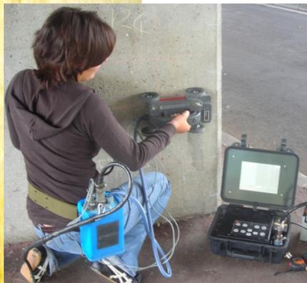
Dans le cadre de la détection et de la caractérisation des armatures (rénovation, réhabilitation d'ouvrages), de la détermination d'épaisseur de la couche d'enrobage (réception d'ouvrage, recherche de corrosion), de la garantie d'un perçage ou forage à l'écart des armatures, ArkoGéos met en œuvre deux méthodes complémentaires le radar et le Ferroskan.
