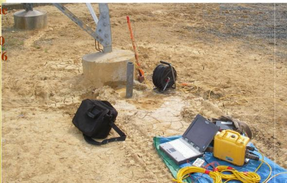
Dans le cadre d'expertise d'ouvrages existants, il existe 2 méthodes qui permettent de déterminer la profondeur de pieux ou palplanches, la Micro Sismique Parallèle et la diagraphe magnétique.
