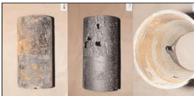
Exemples de canalisations corrodées
