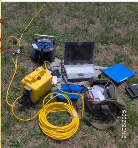
La sismique réfraction a pour objectifs principaux la caractérisation de l'état physique des diverses formations composant le sous sol via le paramètre vitesse sismique ainsi que l'estimation de leur épaisseur.
