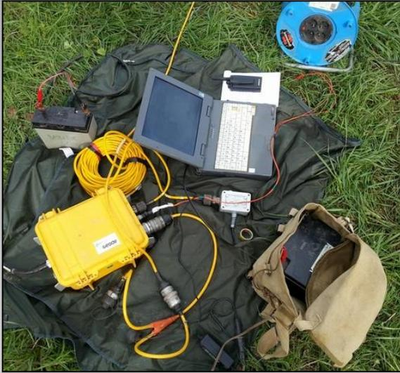
La sismique réfraction a pour objectifs principaux la caractérisation de l'état physique des diverses formations composant le sous sol via le paramètre vitesse sismique ainsi que l'estimation de leur épaisseur.
