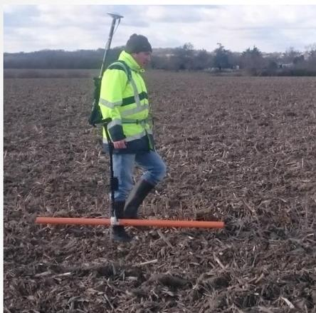
Mesures de la résistivité du sol à plusieurs profondeurs par la méthode des « 4 terres » (cas des prises de terre pour les futurs postes électriques et remontées aéro-souterraines)
