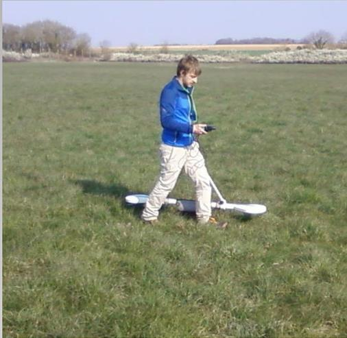
L'étude de corrosivité par les sols (phénomènes électrochimiques) va employer plusieurs techniques de mesures permettant d'évaluer le potentiel corrosif des terrains selon les normes AFNOR A 05-250 et NF-EN 12501-1 et 12502-2.
