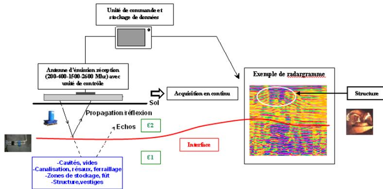
Dans le cadre du diagnostic de l'état de digues, l'utilisation du radar géologique permet de mettre en évidence les éventuels désordres du parement et/ou du corps de digue.
