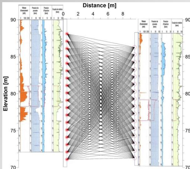
L'enregistreur sismique fournit les temps de propagation des ondes sismiques entre le point d'émission et les divers capteurs du dispositif (hydrophones et, éventuellement, géophones). La tomographie sismique a pour base l'étude de ce temps de propagation.
