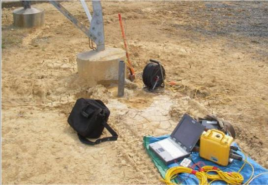
Dans le cadre d'expertise d'ouvrages existants, et afin de déterminer la profondeur des fondations, la méthode de Micro Sismique Parallèle (MSP) peut être utilisée.
