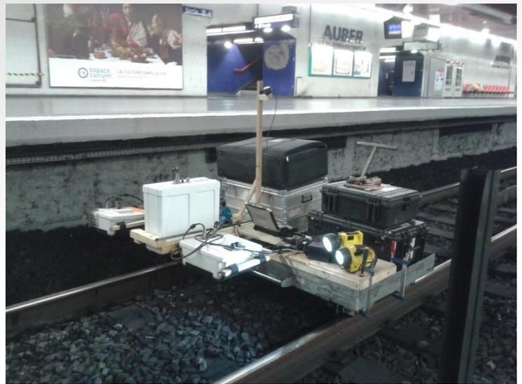
Exemple d'installation sur lorry SNCF (système IDS, 2 antennes 400/900 MHz + 1 antenne 2 GHz)
