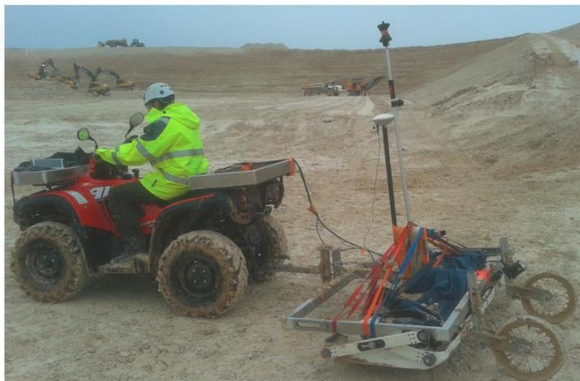
Le multiplexage des antennes sur un seul poste d'acquisition (2 à 48 antennes sériées) et le couplage à des outils de positionnement (DGPS, station totale) permet une prospection exhaustive de grandes surfaces à des vitesses de l'ordre de 10 à 15 km/h.
