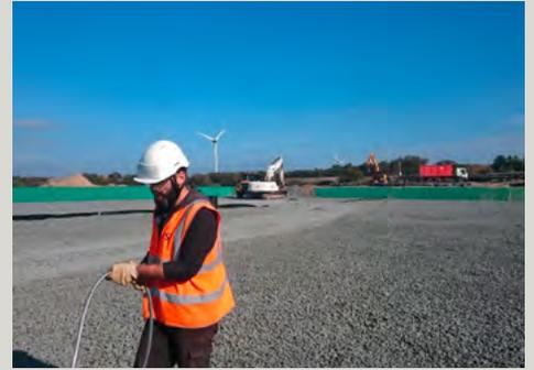
Composé d'un couple dipôle émetteur/dipôle récepteur piloté par un logiciel dédié, l'outil GeoTT® (conforme à la norme ASTM D7007) est à la pointe dans le domaine de la détection de perforations sur géomembrane confinée.
