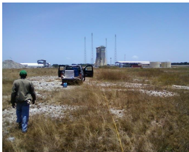
Acquisition par panneaux électriques (Guyane Française)
