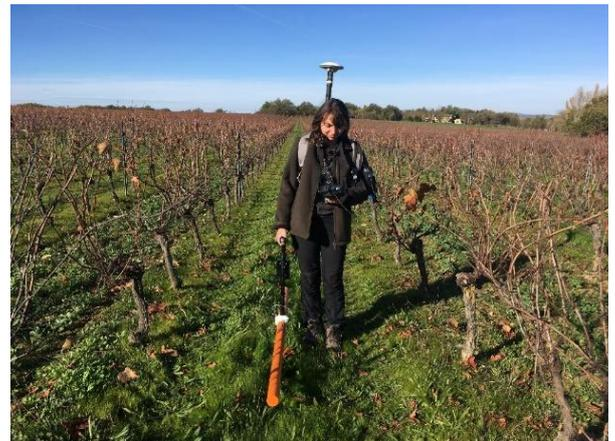
Le conductivimètre **CMD-Mini Explorer 6L** est constitué de 7 bobines, une émettrice et 6 réceptrices, reliées entre elles par une barre de 1.50 m de longueur. Il permet un enregistrement de 6 dipôles simultanés (6 profondeurs d'investigation)
