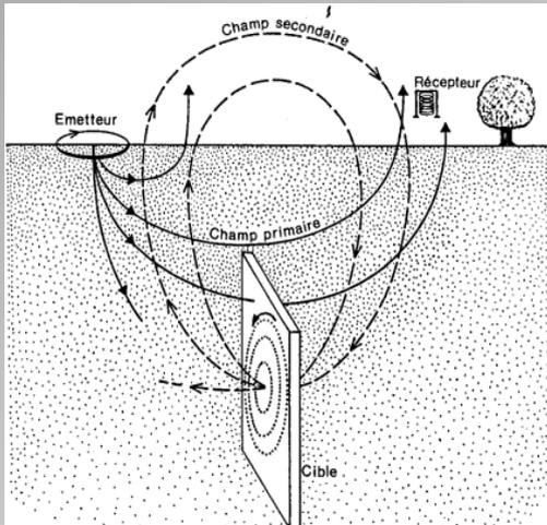
Les méthodes électromagnétiques comme les méthodes électriques consistent à caractériser le sous-sol par la valeur de sa conductivité (inverse de la résistivité).
