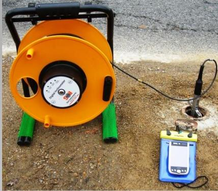
La mesure inclinométrique est utilisée pour le contrôle des déplacements horizontaux des terrains dans les zones de glissement et dans les remblais. Elle est aussi utilisée pour la mesure de la déflexion de structures sous charge telles que mur de soutènement, paroi moulée, pile de pont, pieu.
