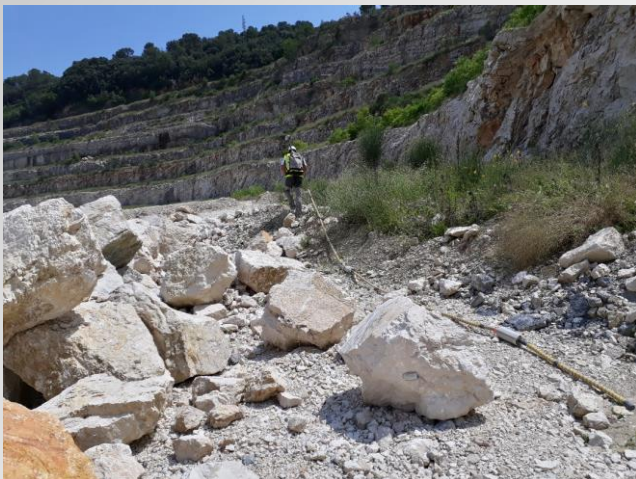
Exemple d'acquisition en terrain accidenté (système MALA, antenne RTA 50MHz)
