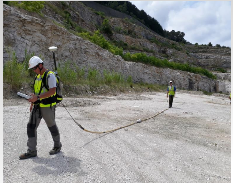
Acquisition antenne RTA 50MHz sur une carrière de dolomies
