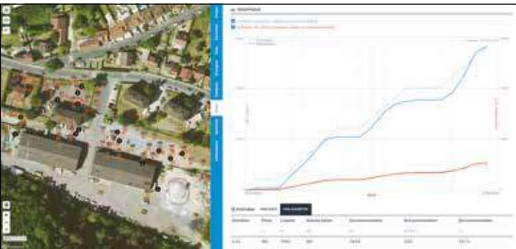
Exemple de vue de l'outil de suivi de production d'un chantier de pieux.
