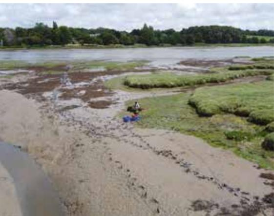
**L'équipe a déployé deux lignes de 475 m et 535 m, de respectivement 96 et 108 électrodes.**
